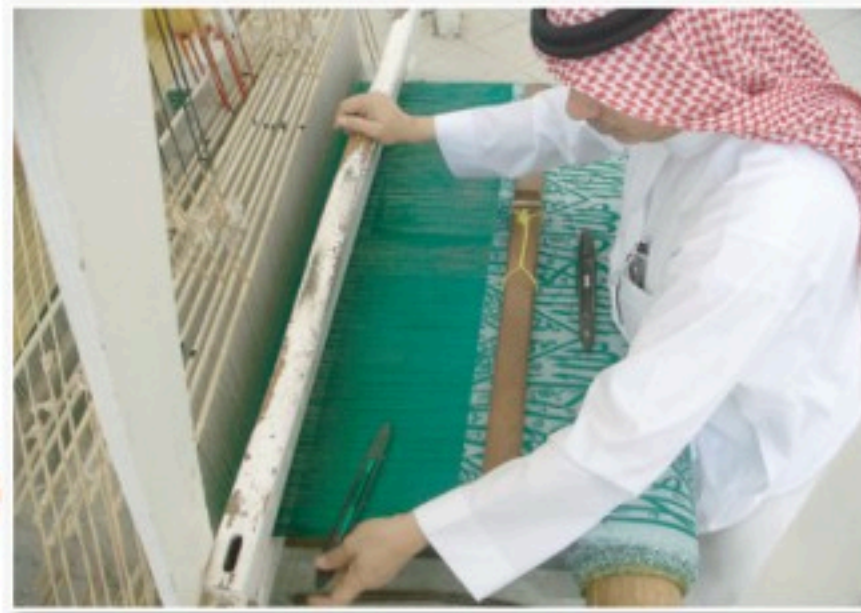
الشكل (٦٠): نلاحظ كيف يمرر النسيج المكوك.
