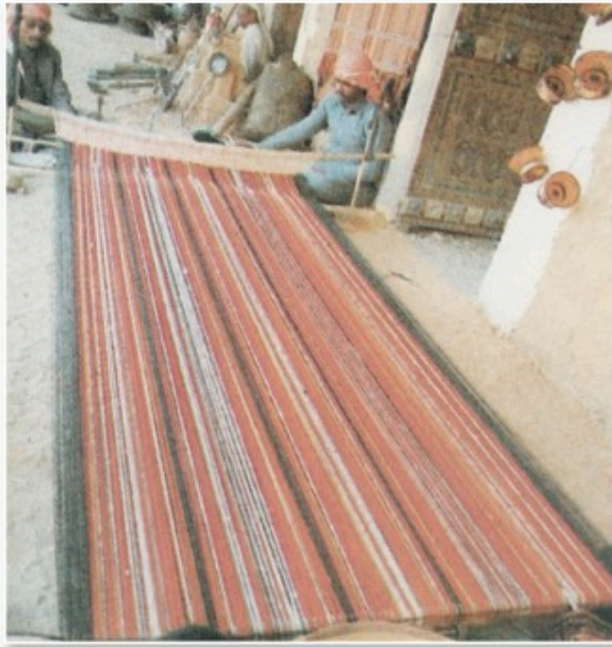
الشكل (٦٣): نول أرضي لإنتاج قطعة كبيرة.
