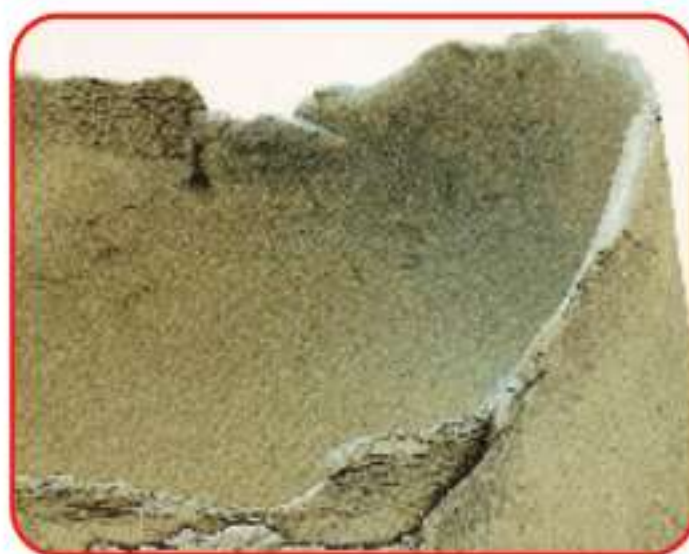
شكل ( ٥٢ ) : يوضح نتائج أخطاء التجفيف ( تشقق ).
