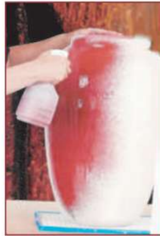
الشكل (١٠) : استخدام البخاخة في تطبيق البطانات .
