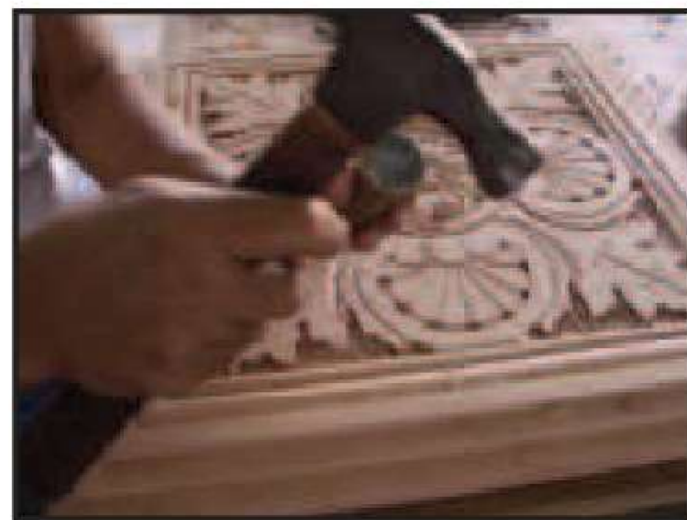
(٢): استخدام الجزء الجانبي للمطرقة، وهي طريقة بديلة، لكن الأفضل استخدام المدق الخشبي.
