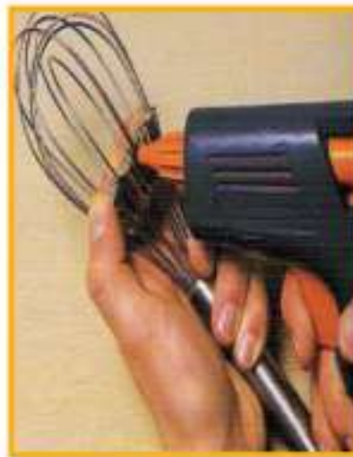
الشكل (٤٦): النوع الثاني ( لحام البارد باستخدام الصمغ )
