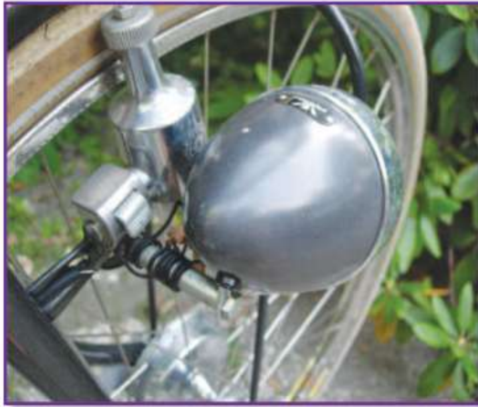
يتصل المولد الكهربائي بعجلة الدراجة
