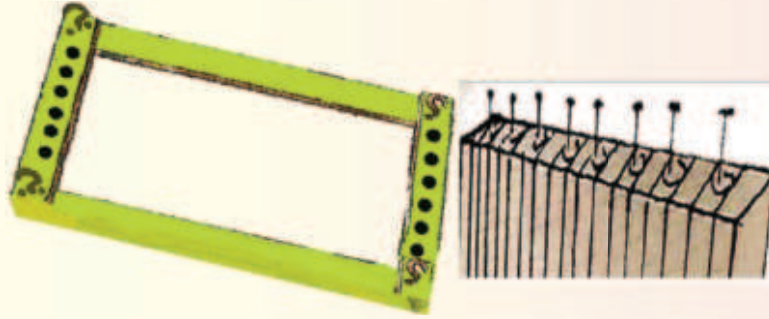
الشكل (٧٨): طريقة تثبيت المسامير على أضلاع النول.
