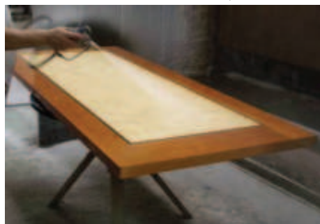
الشكل ( ٦٢ ) : باب خشبي مغطى بثلاثة أنواع من قشرة الخشب . ويلاحظ أن الحرفي يقوم بتغطيته بطبقة من الورنيش حمايته .
