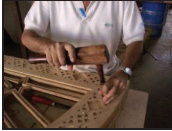
(١) : استخدام المدق الخشبي، وهي الأداة الصحيحة.
