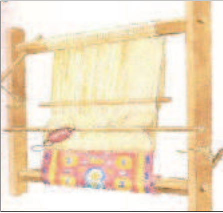
الشكل (٧٧): نول الكليم ويلاحظ فيه تباعد خيوط السدى بما يتناسب مع التصميم المرسوم.
